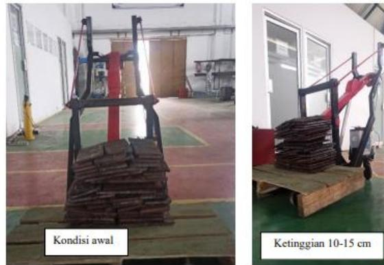
**Gambar 14.** Pengujian angkat besi plat 200 kg
