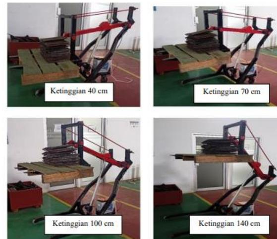
**Gambar 13.** Pengujian angkat besi plat 150 kg
