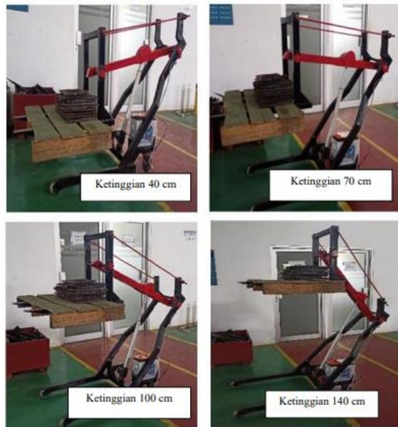
**Gambar 12.** Pengujian angkat besi plat 100 kg
