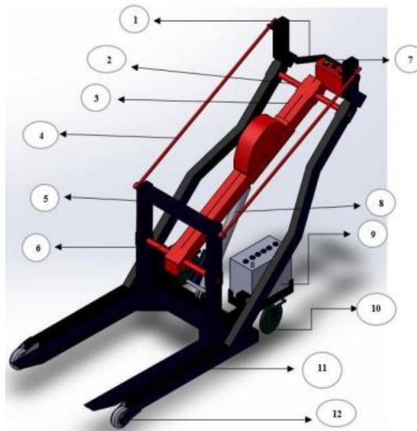
Keterangan: 1. Pegangan, 2. Poros rangka, 3. Mast, 4. Penyetel garpu, 5. Garpu, 6. Poros garpu, 7. Tombol, 8. Aktuator, 9. Aki, 10. Roda belakang, 11. Rangka, dan 12. Roda depan
