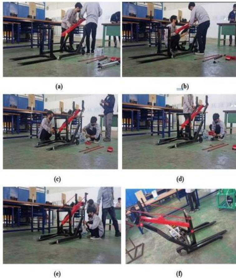
**Gambar 9.** (a) Proses pemasangan mast, (b) Proses pemasangan aktuator, (c) Proses pemasangan garpu, (d) Proses pemasangan tombol, (e) Proses instalasi, (f) Forklift mini
