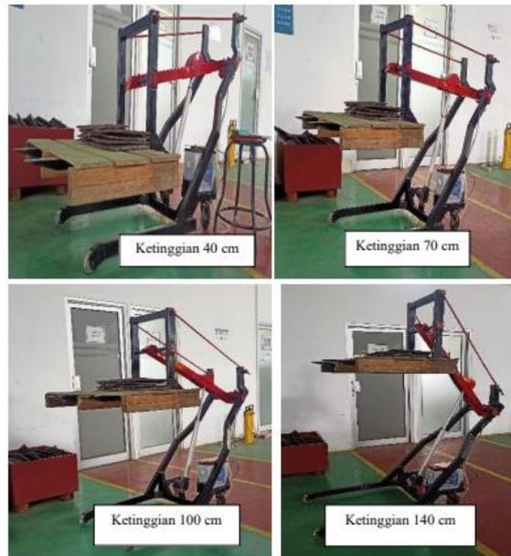
**Gambar 11.** Pengujian angkat besi plat 50 kg
